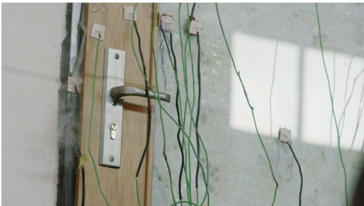
Dveře během požárních zkoušek.
