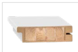
Svislý rám z vrstveně lepeného dřeva obložený deskami HDF a MDF, dostupný za příplatek za dekor: BÍLÁ PREMIUM, DUB NATUR PREMIUM, JASAN GRAFIT PREMIUM, JAVOR ŠEDÝ PREMIUM, DUB ST CPL
